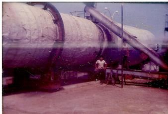
En el secado en paralelo la capacidad de secado la determinan la suma de capacidades de los secadores.
